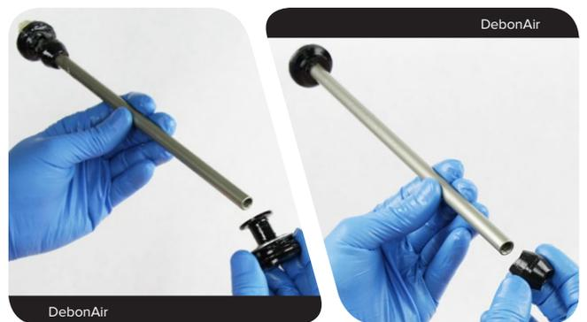
**7 Dual Position Air™** : retirez les joints toriques interne et externe situés sur le piston pneumatique, puis jetez-les. Nettoyez le piston pneumatique.
