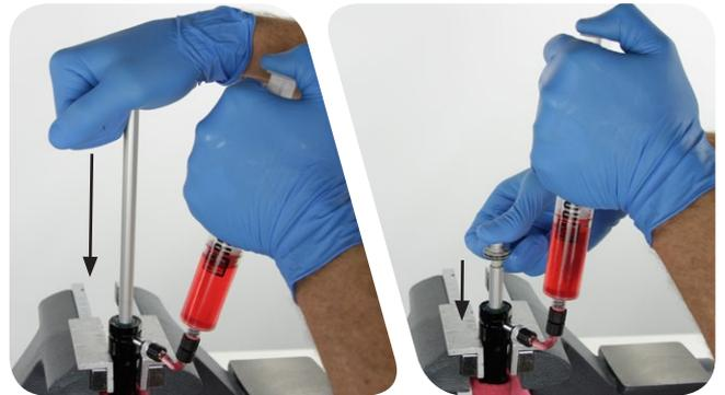
Tirez lentement la came de l'amortisseur du rebond hors du tube de la cartouche tout en opposant une certaine résistance sur le piston de la seringue au fur et à mesure que l'amortisseur se remplit d'huile.
