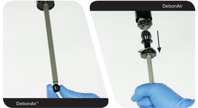
**6** Retirez la tête d'étanchéité, le ressort ondulé, la rondelle de blocage et la butée de talonnage situés sur la came du ressort pneumatique.
