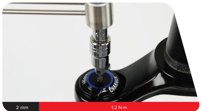
**3b** **RCT R** : mettez le collier d'arrêt du câble en place avec le guide du câble tourné vers l'avant.
