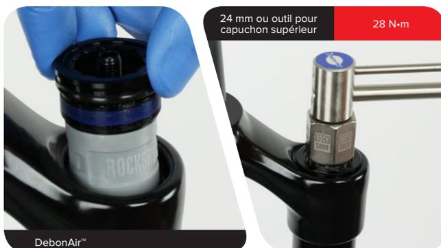
**11 Dual Position Air™** : mettez en place la molette de réglage sur le capuchon supérieur en veillant à ce que la longue languette soit tournée vers l'arrière du té. Tournez la molette de réglage dans le sens inverse des aiguilles d'une montre jusqu'à ce qu'elle s'enclenche dans le premier cran.
