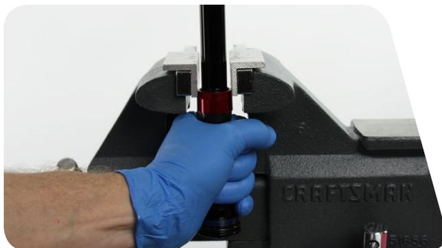
**11** Retirez le tube hors de l'étau. Tournez le tube la tête en bas et pressez la vessie jusqu'à ce que tout le produit de nettoyage et toute l'huile restante se soient écoulés dans le récipient prévu à cet effet.
