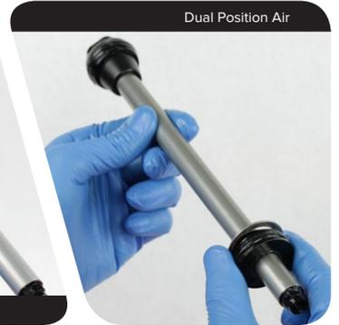
**5** Appliquez de la graisse sur le piston pneumatique et les joints/joints toriques externes de la tête d'étanchéité.
