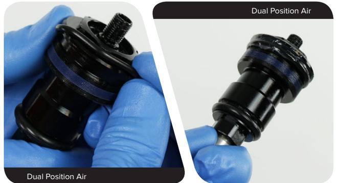
**4 Dual Position Air™** : poussez la came pneumatique dans le tube supérieur afin d'éviter qu'elle ne se raye lors du démontage de l'anneau de blocage.
