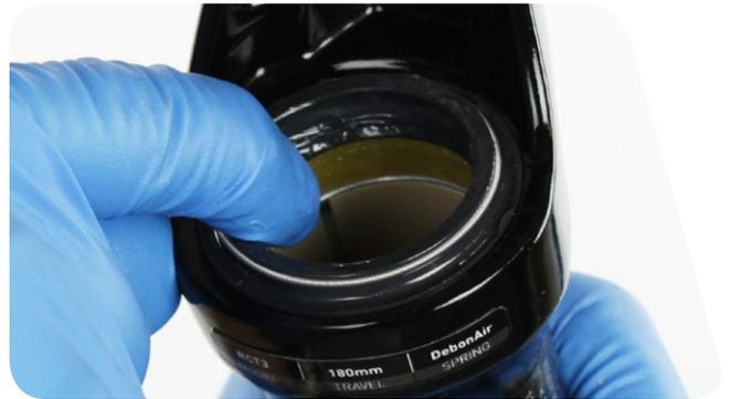
3 Faites coulisser l'unité des fourreaux inférieurs sur les tubes supérieurs de manière à ce que seules les bagues supérieures s'engagent dans les tubes supérieurs.
