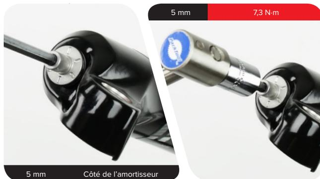
**8** **Lyrik™** : mettez la molette de l'amortisseur du rebond en place puis serrez la vis de fixation.
