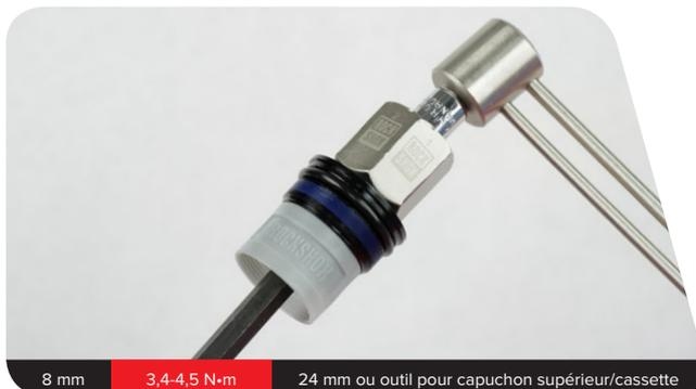
**Dual Position Air™** : au besoin, installez des Bottomless Tokens sur la came du ressort pneumatique DPA.
