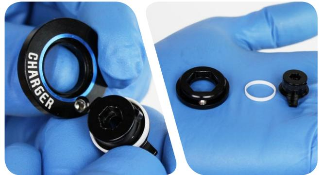
Mettez en place la bobine de la commande à distance sur la tige de réglage hexagonale de manière à ce que la vis de fixation du câble de la bobine se trouve dans la zone à 87°.
